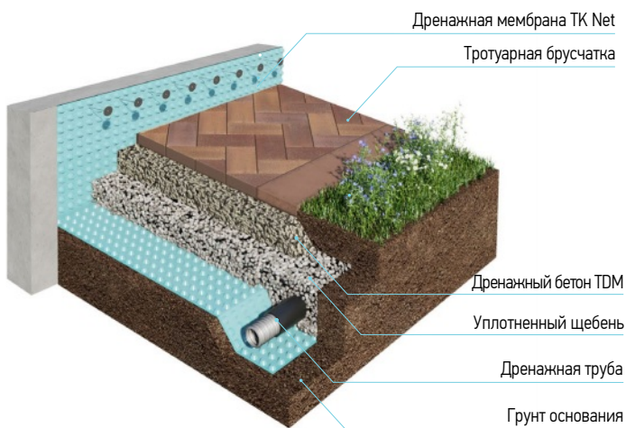
3 Отмостка с применением дренажной мембраны TK Net на мягком основании с применением дренажного бетона
